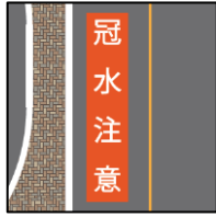
ちゅういかんき 注意喚起 ろめんひょうじ 路面標示
