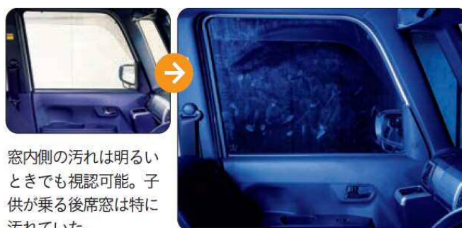
ブラックライトによるドアガラスの汚れ (ウ: 車内の見えない汚れ)
