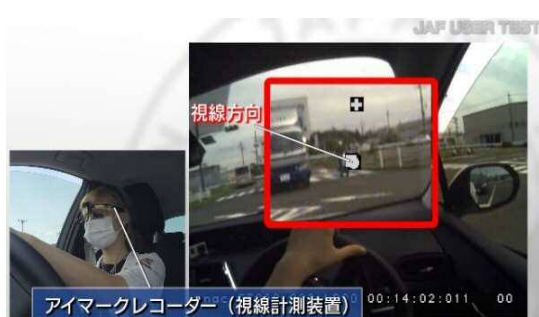
ドライバーの視線を計測 (イ: 死角)
