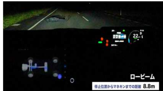
路上寝込み事故テストの様子
