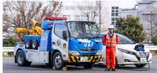
ポータブル充電器を搭載したサービスカー
