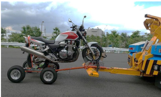
二輪アタッチメントを使用したけん引
