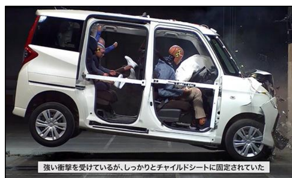
衝突時の様子（左：チャイルドシート不使用、右：正しくチャイルドシートを着用）
