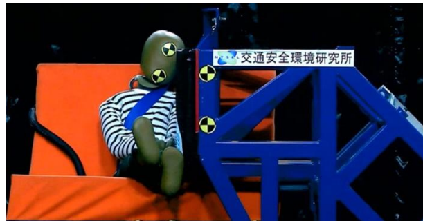
衝突時の様子（左：正しい取付け方法でテスト、右：シートベルトを使用した場合でテスト）
