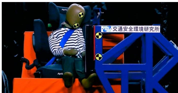
衝突時の様子（左：正しい取付け方法でテスト、右：シートベルトを使用した場合でテスト）
