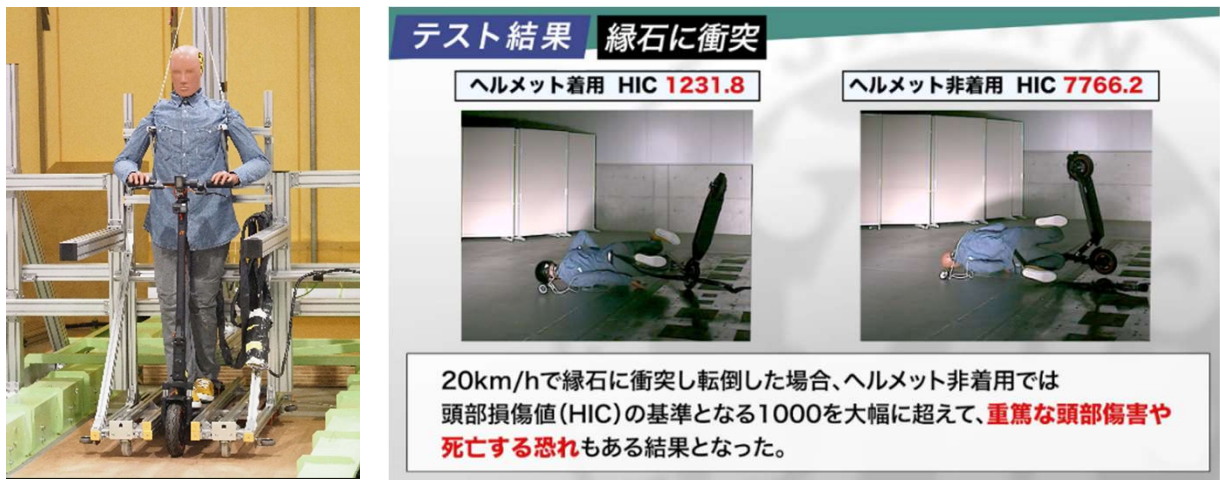
実験の様子と転倒時の頭部損傷値(HIC)
