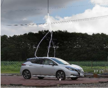
車のルーフに落雷させた様子
