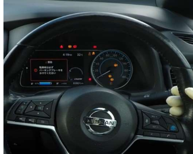
落雷後のインジケーターの警告灯
