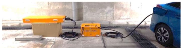
ポータブル充電器（レッカー車搭載）での充電の様子
