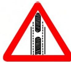
中央分離帯に途切れあり (中央分離帯のある道路)
