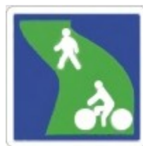
グリーン車線：歩行者と 原動機なしの車両のみ使用可
