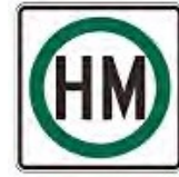
危険物積載車両通行止め
